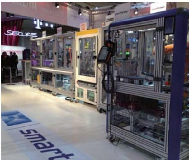
図5 ハノーバー見本市における展示①(スマートファクトリー・デモ装置) 通信規格の異なる各社の装置をつなげて、名刺ホルダーの個別大量自動生産装置をデモ展示している。
