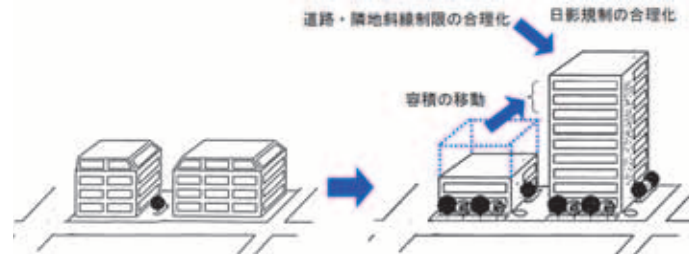
図 10 一団地の総合的設計制度のイメージ(出典:国土交通省 HP)
