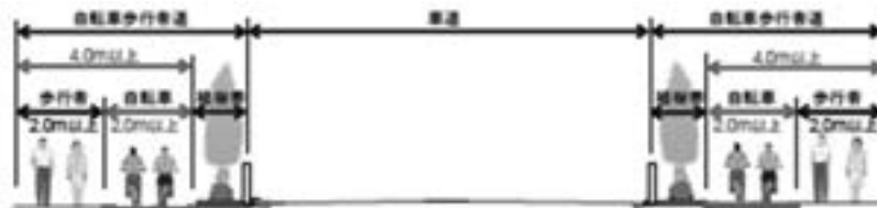
図-4 標準的な断面構成（自歩道の視覚的分離） 15
