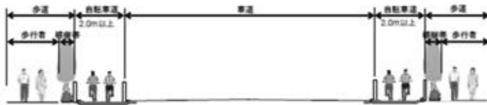
図-1 標準的な断面構成（自転車道） 12
